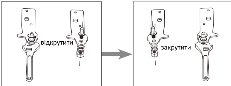
6. Встановіть можнажну планку з потрібної сторони приладу та закрутіть ніжки що налаштовуються.
