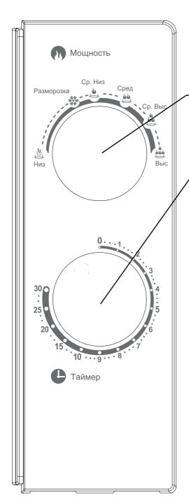
Панель управління складається з двох функціональних частин: куляста ручка вибору потужності і ручка таймеру.
