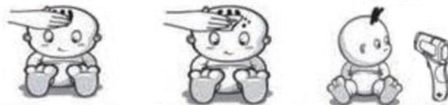
1. Приберіть волосся 2. Необхідно витерти піт 3. Відстань для вимірювання 3-5 см
